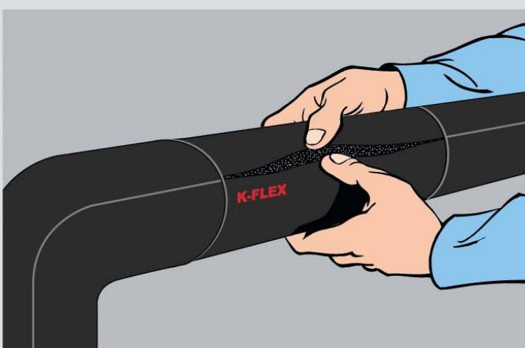
**5** Разрежьте вставку вдоль и смонтируйте на трубопроводе также, как и основные изоляционные трубы.
