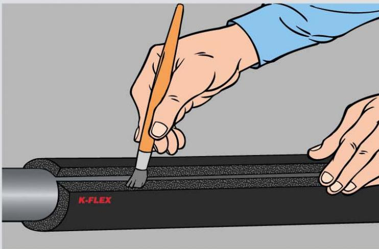
**2** Поместите изоляцию "K-FLEX" на трубу так, чтобы ее разрезанные края были отдалены друг от друга. Нанесите ровный слой клея "K-FLEX" на оба края разреза.
