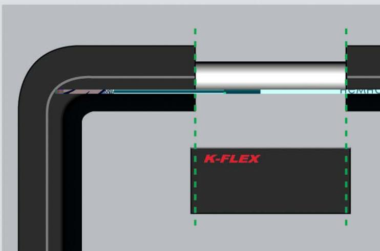
**4** При выполнении соединения двух уже смонтированных участков изоляции вырежьте кусок трубы "K-FLEX" **чаще всего длиннее (на 2 мм)** места вставки.
